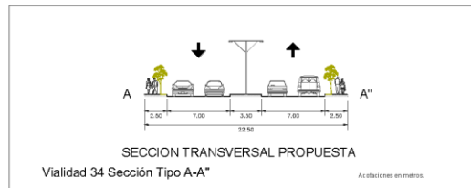
Figura 256. Sección transversal propuesta de Vialidad El Orito-Picones.
