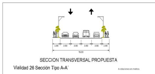
Figura 336. Sección transversal propuesta de Vialidad B Bracho-La Escondida (Camino de Minas).
