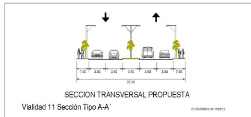
Figura 296. Sección transversal propuesta de Vialidad Fraccionamiento Ganaderos.
